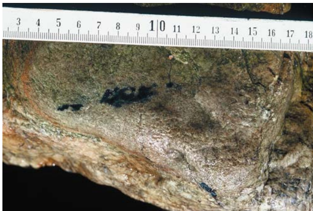
Abb. 8 > Stein mit wenig Eisensulfid (FeS).
